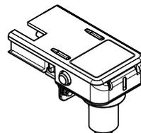
Rechter Anschluss für Cappuccinatore: Der Cappuccinatore kann an den Milchbehälter angeschlossen werden, der auf der rechten Seite der Maschine positioniert ist.
