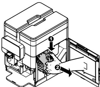
Die Brühgruppe mit lauwarmem Wasser reinigen; den oberen Filter sorgfältig reinigen. Bevor die Brühgruppe in ihre Aufnahme eingesetzt wird, ist sicherzustellen, dass kein Wasser in der Brühkammer verblieben ist.
