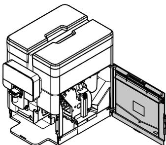
Die Brühgruppe herausnehmen, indem sie am entsprechenden Griff gehalten und die Taste «PRESS» gedrückt wird. Die Brühgruppe darf ausschließlich mit lauwarmem Wasser ohne Reinigungsmittel gereinigt werden.
