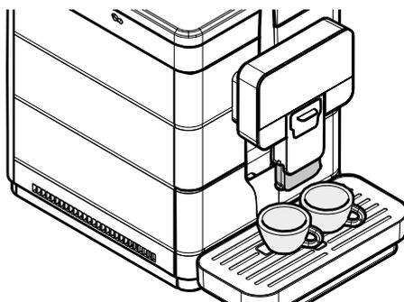
Den Auslauf bis zum Anschlag in die Maschine schieben, um hohe Gläser oder MUG benutzen zu können. In diesem Falle kann lediglich jeweils ein Produkt ausgegeben werden.
