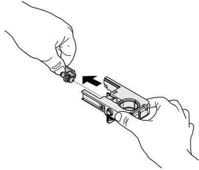
Die Teile unter laufendem Wasser reinigen. Sicherstellen, dass eventuelle Ablagerungen/Verkrustungen der Milch entfernt wurden. Nach der Reinigung alle Bestandteile wieder in umgekehrter Reihenfolge montieren.
