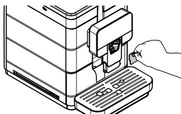
Den Cappuccinatore bis zum Anschlag in seine Aufnahme einstecken. Kontrollieren, dass dieser nicht heraus rutschen kann.
