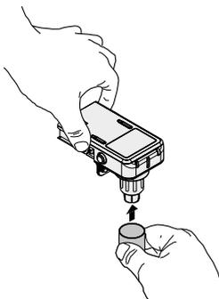
Den Schlauch auf der linken Seite des Anschlusses einsetzen.
