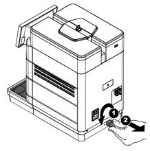
Den Schlauch des Wassernetzes an die Muffe 3/4" des Gerätes anschließen.
