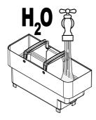
Wenn das Gerät an das Wassernetz angeschlossen und darauf eingestellt ist, setzen Sie den leeren Tank in die Maschine wieder ein.
