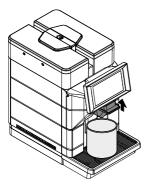
Führen Sie den zweiten Entkalkungsschritt, d.h. das Spülen, durch. Warten Sie, bis der Spülvorgang abgeschlossen ist.
