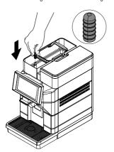
Den Tank aus der Maschine herausnehmen und leeren. dieser wird an den im Inneren angebrachten Handgriffen angehoben.
