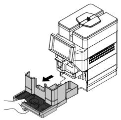
Die Schraube entfernen, die das unbeabsichtigte Öffnen der Klappe des Ausgabefachs verhindert. (\* nur in der I20-V-USA-Version)
