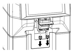
Waschen Sie die Düsen unter fließendem Wasser, indem Sie sie leicht abwaschen. Sicherstellen, dass eventuelle Ablagerungen/Verkrustungen der Milch entfernt wurden. Nach der Reinigung alle Bestandteile wieder in umgekehrter Reihenfolge montieren.
