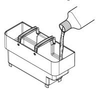
Wasser bis zum Füllstand "CALC CLEAN" in den Die Abtropfschale entfernen und entleeren. Wassertank einfüllen.
