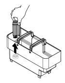
In den Wassertank 250 ml Entkalkungsmittel füllen.
