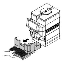
Nach dem Leeren die Abtropfschale wieder einsetzen. Stellen Sie einen großen Behälter unter die Düsen.
