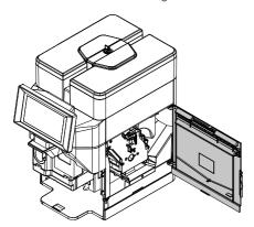
Der Zugang zu den Menüs durch Öffnen der Klappe sollte nur verwendet werden, wenn ein normaler Zugang über das Tablet nicht möglich ist.
