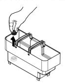
Den Wasserfilter in den leeren Tank einsetzen. Bis zum Einrasten drücken.
