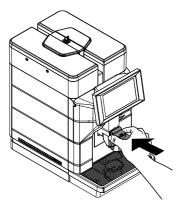
Führen Sie den sauberen Ansaugschlauch in ein leeres Gefäß mit einem Fassungsvermögen von mindestens 250 ml ein.
