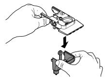
Entfernen Sie alle Teile der unteren Abdeckung des Capuccinatore wie in der Abbildung gezeigt.
