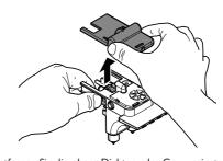
Entfernen Sie die obere Dichtung des Cappuccinatore.
