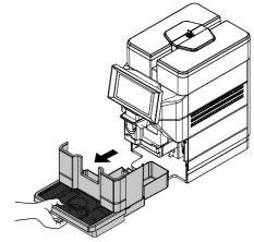
Nach dem Leeren die Abtropfschale wieder einsetzen. Stellen Sie einen großen Behälter unter die Düsen.
