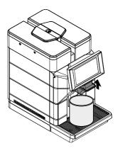
Führen Sie den ersten Entkalkungsschritt durch. Befindet sich keine Entkalkungslösung mehr im Tank, fordert die Maschine zur Entleerung und Spülung des Tanks mit frischem Trinkwasser auf. Den Wassertank gründlich ausspülen.
