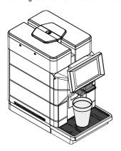
Auf das Symbol "Hot Water" tippen, um die Ausgabe von HEISSEM WASSER zu starten. Nach Abschluss der Ausgabe des heißen Wassers den Behälter leeren. Die Maschine ist betriebsbereit.
