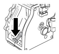
Sicherstellen, dass sich der Haken für die Sperre der Brühgruppe in der korrekten Position befindet; Um deren Position zu überprüfen, muss die Taste "PUSH" fest gedrückt werden.
