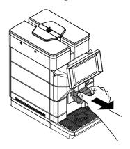
Entfernen Sie die beiden Dosierdüsen wie abgebildet.
