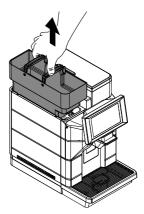
Entfernen Sie den Kalkfilter aus dem Wassertank, falls vorhanden. (Nur wenn das Gerät an das Wassernetz nicht angeschlossen und darauf eingestellt ist).
