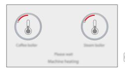
Die Balken rücken vor und zeigen an, dass das Gerät das System aufwärmt.
