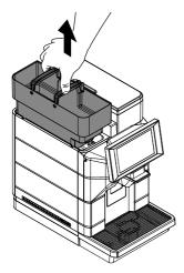
Ausspülen und mit frischem Wasser füllen; der im Tank angegebene maximale Füllstand (MAX) darf nicht überschritten werden.
