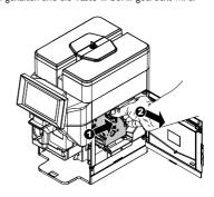
Die Brühgruppe darf ausschließlich mit lauwarmem Wasser ohne Reinigungsmittel gereinigt werden. Die Brühgruppe mit lauwarmem Wasser reinigen; den oberen Filter sorgfältig reinigen. Bevor die Brühgruppe in ihre Aufnahme eingesetzt wird, ist sicherzustellen, dass kein Wasser in der Brühkammer verblieben ist.
