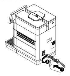
Schlauch 🖙 Der Wasseranschlusses muss gemäß des Standards IEC 61770 zertifiziert sein.
