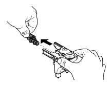
Entfernen Sie die untere Abdeckung des Cappuccinatore.
