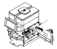
Die Reinigungstablette in die Brühgruppe einwerfen und die Brühgruppe wieder in die Maschine einsetzen. Darauf achten, dass alle Teile eingesetzt wurden und die Tür schließen.
