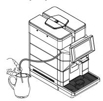
Leeren Sie den Behälter unter den Auslaufdüsen aus. Die Abtropfschale entfernen und entleeren.
