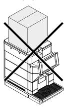
Aufgrund des Gesamtgewichts ist die Stapelung von mehr als drei Maschinen verboten. Die Maschine muss in der Originalverpackung trocken und/oder vor Staub geschützt eingelagert werden.
