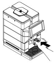
Führen Sie den sauberen Ansaugschlauch in ein leeres Gefäß mit einem Fassungsvermögen von mindestens 250 ml ein.
