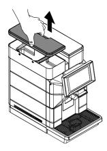
Den Tank entfernen; dieser wird an den im Inneren angebrachten Handgriffen angehoben.
