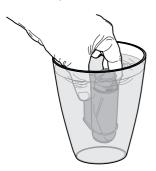
Den Tank aus der Maschine herausnehmen und leeren. Den kleinen weißen Filter aus dem Tank herausnehmen, an einem trockenen Ort aufbewahren und vor Staub schützen.
