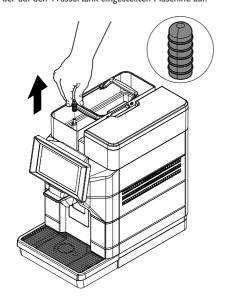
Setzen Sie den Deckel des Wassertanks wieder auf. Die Schutzabdeckung wieder aufsetzen, wie im Abschnitt "Schließung obere Abdeckung" beschrieben. Speichern Sie die Einstellungen und verlassen Sie das Programmiermenü.
