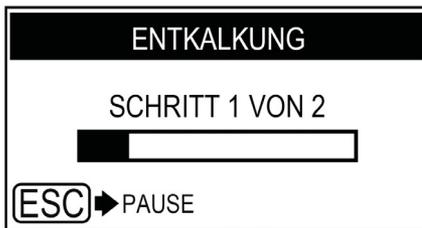
Ist kein so großer Behälter zur Hand, wird der Zyklus durch Druck der Taste "Standby" in den Pausenmodus geschaltet, der Behälter entleert und erneut in die Maschine eingesetzt. Dann wird der Zyklus fortgesetzt, indem die Taste "Kaffee" gedrückt wird.
