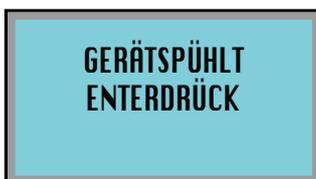
Einen Behälter mit 1 Liter frischem Wasser aufstellen und die Taste **ENTER**
