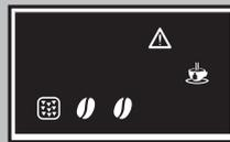
12 Den Tank wieder in die Maschine ein-setzen. Die beiden LED "●" leuchten dauerhaft auf, um anzuzeigen, dass sich die Maschine in der Spülphase befindet. Auf dem Display blinken die LED "☕" und "▲".
