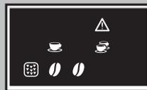
14 Blinken die LED "▲", "☕" und "☕" gleichzeitig, muss der Wahlschalter in die mittlere Position "●" gedreht werden.
