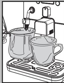
20 Einen leeren Behälter unter die Dampfduüse und einen Behälter unter den Auslauf stellen.
