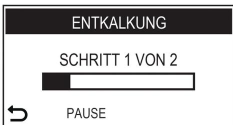
Ist kein so großer Behälter zur Hand, wird der Zyklus durch Druck der Taste "Spezialgetränke" in den Pausenmodus geschaltet, der Behälter entleert und erneut in die Maschine eingesetzt. Dann wird der Zyklus fortgesetzt, indem die Taste "Kaffee" gedrückt wird.
