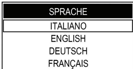
Die gewünschte Sprache durch Druck der Taste „Cappuccino“ oder der Taste „Latte Macchiato“ anwählen.
