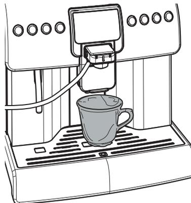
Die Taste "Cappuccino" gedrückt halten, bis die Meldung "MEMO" angezeigt wird und dann loslassen. Nun befindet sich die Maschine im Programmiermodus.
