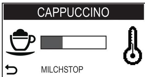
In dieser Phase gibt die Maschine die aufgeschäumte Milch aus. Die Ausgabe kann durch Druck der Taste "Spezialgetränke" beendet werden.
