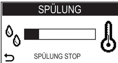
Warten, bis dieser Zyklus automatisch beendet wird; die Ausgabe kann durch Druck der Taste "Spezialgetränke" abgebrochen werden.
