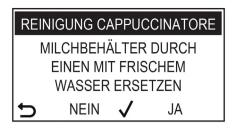
Sicherstellen, dass der Cappuccinatore über alle Bestandteile verfügt und korrekt eingesetzt wurde. Einen Ansaugschlauch in eine Karaffe einstecken, die sauberes Wasser enthält.
