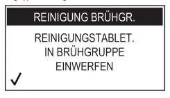
Die Reinigungstablette in die Brühgruppe einwerfen und die Brühgruppe wieder in die Maschine einsetzen. Darauf achten, dass alle Teile eingesetzt wurden und die Tür schließen.
