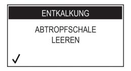
Alle vorhandenen Flüssigkeiten aus der Abtropfschale entleeren und die Abtropfschale wieder in die Maschine einsetzen.
