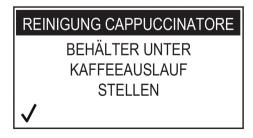
Einen leeren Behälter mit einem Fassungsvermögen von mindestens I Liter unter den Auslauf stellen und die Taste "Kaffee" zur Bestätigung drücken. Die Maschine führt einen Reinigungszyklus des Cappuccinatore aus.
