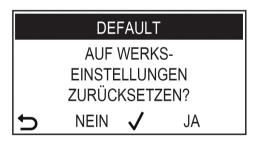
Bei der Wiederherstellung werden die gespeicherten Daten endgültig gelöscht. Um den Vorgang zu verlassen, die Taste "Spezialgetränke" drücken. Zur Bestätigung die Taste "Kaffee" drücken. Das Getränk wurde auf die werkseitigen Werte zurückgesetzt. Die Taste "Spezialgetränke" ein- oder mehrmals drücken. um das Menü zu verlassen.
