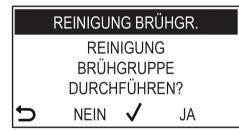
Sollte diese Option bestätigt werden, so muss der Zyklus in jedem Falle abgeschlossen werden. Die Taste "Spezialgetränke" zum Verlassen drücken.
