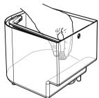
Den Wasserfilter in den leeren Tank einsetzen. Bis zum Einrasten drücken.
