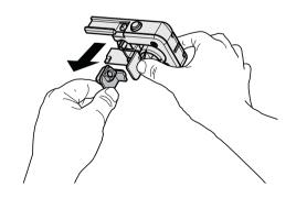
Die Teile unter laufendem Wasser reinigen. Sicherstellen, dass eventuelle Ablagerungen/Verkrustungen der Milch entfernt wurden.
