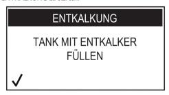
Die auf der Flasche angegebene Menge von konzentriertem Entkalker Saeco in den Wassertank des Geräts einfüllen und den Tank mit frischem Trinkwasser bis zu dem Füllstand auffüllen, der mit dem Symbol "Calc Clean" gekennzeichnet ist.
