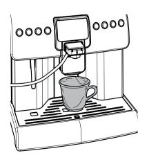
Die Taste "Cappuccino" gedrückt halten, bis die Meldung "MEMO" angezeigt wird und dann Ioslassen. Nun befindet sich die Maschine im Programmiermodus.
