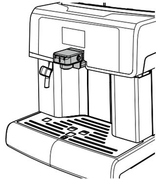
Alle vorhandenen Flüssigkeiten aus der Abtropfschale entleeren und die Abtropfschale wieder in die Maschine einsetzen.
