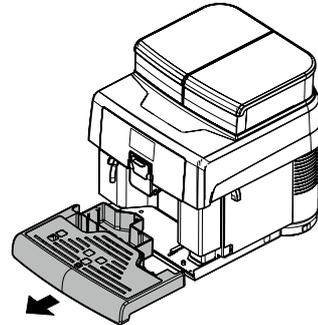
Die Abtropfschale leeren und reinigen.
