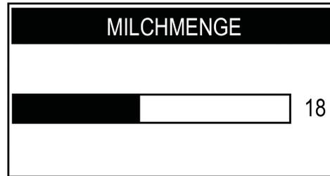
Die Taste „DOWN“ oder die Taste „UP“ für die Anwahl des gewünschten Werts drücken, wenn sich die Leiste füllt; Die seitliche Zahl zeigt den Wert (in Sekunden) hinsichtlich der Leiste an. Nachfolgend zur Bestätigung und zum Verlassen die Taste „OK“ drücken.
