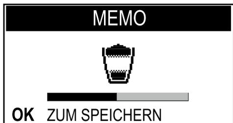
Ab diesem Zeitpunkt muss die Taste „OK“ gedrückt werden, sobald die gewünschte Kaffeemenge in die Tasse ausgegeben wurde. Nun ist die Taste "Cappuccino" programmiert. Bei jedem Druck gibt die Maschine die soeben programmierte Menge aus.
