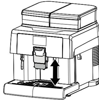
Für diese Einstellung wird der Auslauf von Hand nach oben oder nach unten geschoben.
