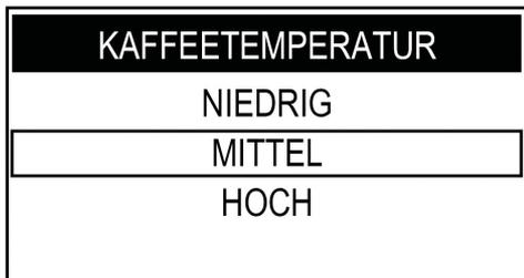
Die Taste „DOWN“ oder die Taste „UP“ für die Anwahl des gewünschten Werts drücken. Nachfolgend zur Bestätigung und zum Verlassen die Taste „OK“ drücken. Die Taste „DOWN“ drücken, um das Menü „TASSENFÜLLMENGE“ anzuwählen.
