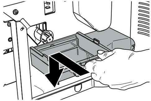
Wenn der Behälter eingesetzt wird, ist die Vorgehensweise zur Herausnahme in umgekehrter Reihenfolge auszuführen.
