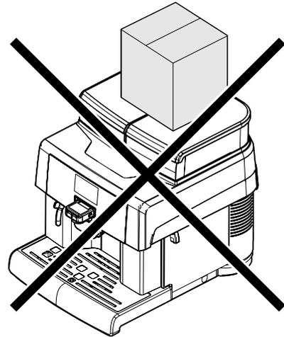
⚠ Aufgrund des Gesamtgewichts ist die Stapelung von mehr als drei Maschinen verboten. Die Maschine muss in der Originalverpackung trocken und/oder vor Staub geschützt eingelagert werden.
