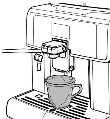
Nach der Ausgabe eines Milchgetränks fordert die Maschine die Reinigung des Cappuccinatore an.
