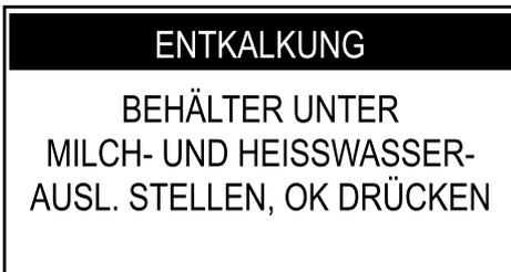
Einen Behälter unter die Heißwasserdüse und einen großen Behälter unter den Cappuccinatore stellen. Die Taste „OK“ drücken.
