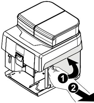
Die Brühgruppe herausnehmen, indem sie am entsprechenden Griff gehalten und die Taste «PRESS» gedrückt wird. Die Brühgruppe darf ausschließlich mit lauwarmem Wasser ohne Reinigungsmittel gereinigt werden.
