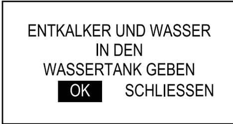
In den Wassertank 250 ml Entkalkungsmittel und 750 ml Wasser füllen. Daraufhin wird folgende Ansicht angezeigt:
