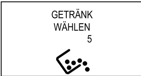
Wird der Behälter nicht geleert, stoppt die Maschine nach einigen weiteren Ausgabezyklen. Auf dem Display erscheint:
