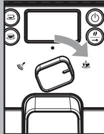
2 Erst nachdem die Entkalkerlösung in den Tank gefüllt wurde, den Wahlschalter im Uhrzeigersinn bis zur Position **“☕”** drehen und 2-3 Tassen Wasser ausgeben (ca. 150 ml).
