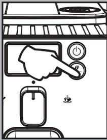
22 Die Taste "
