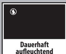
9 Ist kein Wasser mehr im Tank vorhanden, wird das seitlich dargestellte Symbol angezeigt. Dieses zeigt an, dass der Wahlschalter wieder in die Position "●" gestellt werden muss.
