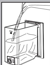
10 Den Tank sorgfältig ausspülen und mit frischem Trinkwasser füllen.
