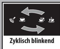
Abwarten, bis dieser Zyklus automatisch beendet wird. **Die Ausgabe kann durch Druck einer der beiden Tasten für die Kaffeeausgabe und/oder die Taste "Standby" unterbrochen werden.**
