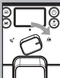
19 Den Wahlschalter im Uhrzeigersinn bis zur Position "☉" drehen.
