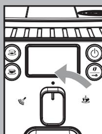
6 Wenn das Symbol auf dem Display angezeigt wird, den Tank sorgfältig ausspülen und mit frischem Trinkwasser füllen.
